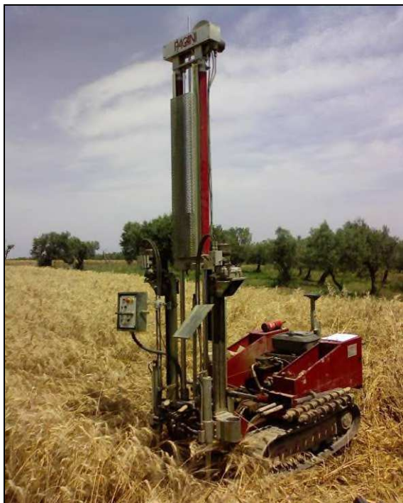
Fig.1-Penetrometro statico-dinamico modello Pagani TG63-200 cingolato semovente.
